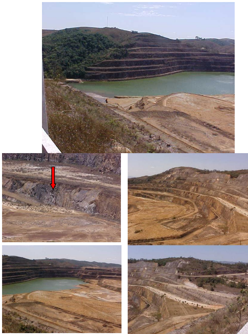
Foto 6.2 a 6.6: Cava da mina - Em alguns locais pode-se perceber afloramentos de Pirita (sulfeto de ferro)
